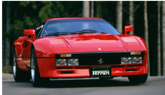
今振り返ると限定生産の“スペチャーレ”フェラーリ初作となつたのがこのGTOだった。以降F40、F50、エンツォ、ラ・フェラーリ、そしてF80と続く。1984年デビューの288GTOはまだ大仰なスピラーやウイングを持たないレオナルド・フィオラヴァンティのクリーンな造形が魅力的だ。400ps以上を発揮するツインターボV8は縦置き。ホイールベースはデザインのベースとなった308GTBに比べ11cm延長されているが、プロポーションに冗長な印象はまったくなく、拡大された全幅、特に筋肉質な前後フェンダーの盛り上がりによって精悍さを増している。F40とともにV8フェラーリの金字塔的モデル。
