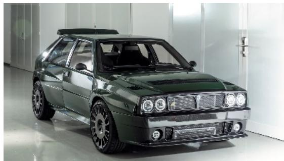
伝説と化した傑作ラリーカー、デルタ・インテグラーレ 16Vの現代的解釈として2018年に発表されたのがフトウリスタ。ボディはオリジナルが5ドアであるのに対し、3ドアに改められている。基本骨格はオリジナルの流用だが、補強箇所は1000以上にのぼる。4気筒ターボユニットはオリジナルを踏襲。ただし330psまでチューンアップ可能という。
