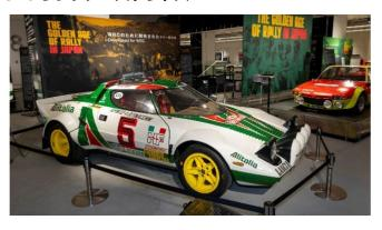
ランチアのモータースポーツ部門を率いる闘将チェーザレ・フィオリオの強いリーダーシップのもと、WRCで勝つことだけを目的に開発された"パーパスビルト"マシーンがこのストラトスHFだ。コクピット背後に搭載するのはフェラーリ・ディーノ用に開発された2.5 ℓ V6。未来的なボディデザインはカロッツェリア・ベルトーネのチーフだったマルチェッロ・ガンディー二が手がけた。コンパクトでパワフル、高い俊敏性を誇ったストラトスはすぐに高い戦闘力を発揮。デビューイヤー
