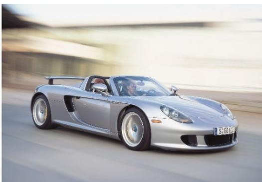
911の文脈からは外れるが、ルマン24時間レースの主役がGTからレーシングスポーツへ移行することを見据え、ポルシェが次期FXとして開発したことから、今回展示ラインナップに加えたのがカレラGTだ。同時期のフェラーリ・エンツォ同様タブもアウトパネルもカーボンファイバー製。インボード・サスペンション含め、そのシャシーはstate of artと呼びたくなるほど美しい。612psを絞り出すミッドシップV10は快音を発することでも有名。ギアボックスは6段MTのみで、発進時のクラッチワークが非常に難しいとされた。
