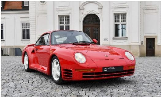
80年代半ば、当時考えられる最新技術すべてをつぎ込んで開発したテクノロジーのショーケースが959だった。2.9ℓまで拡大されたフラットシックスはDOHC化され、最大出力は450psに到達。このパワーをフルに引き出すために電子制御トルクスプリットのフルタイム4WDシステムも採用されている。いわばハイテクモンスター。フェラーリ288GTO同様グループB参戦を目指したモデルだが、「危険すぎる」という理由からカテゴリーが消滅し、パリダカやルマン24時間に舞台を替え活躍した。
