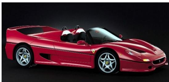
基本コンセプトは路上を走るF1。その基本思想はセンターモノコックがフェラーリ初のフルカーボン・ファイバー製であることから明らかだ。520psを發揮する4.7ℓ V12自然吸気エンジンは、92年型F1のF92Aから流用し、リアバルクヘッドにリジッドマウントされている。プッシュロッド式インボード・サスペンションを採用する等、徹底的に当時のF1テクノロジー導入を図った。
